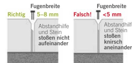
Die Steine dürfen nicht knirsch (direkter Kontakt der Steine) verlegt werden, da auftretende Spannungen (Temperatur, Belastung) in der Fläche nicht ausgeglichen werden und somit Schäden wie z. B. Abplatzungen auftreten können.
